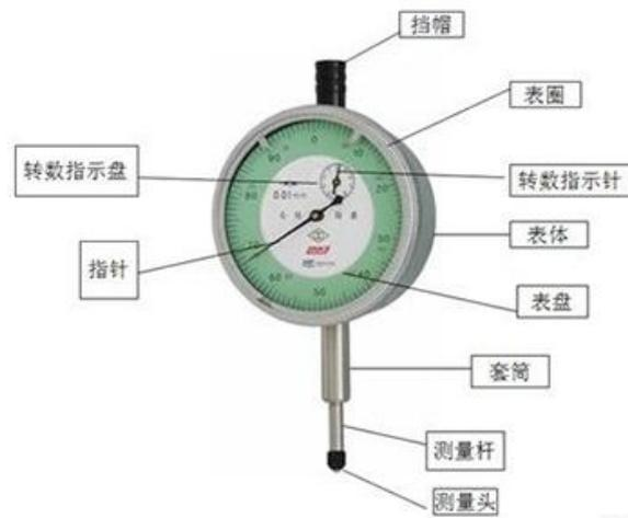
百分表的工作原理,是将被测尺寸引起的测杆微小直线移动,经过齿轮传动放大,变为指计在刻度盘上的转动,从而读出被测尺寸的大小。百分表是利用齿条齿轮或杠杆齿轮传动,将测杆的直线位移变为指针的角位移的计量器具。
